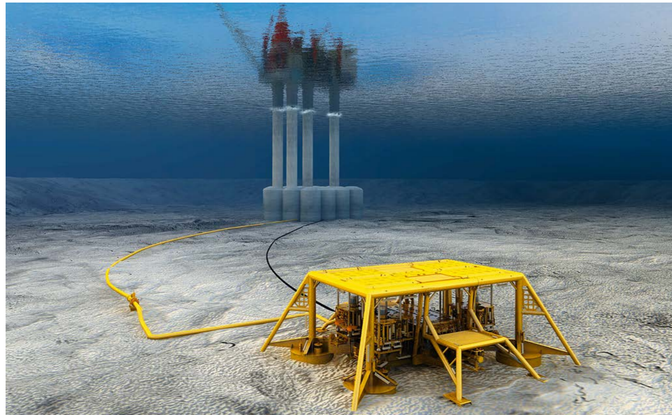
РИС. 8. Электроснабжение и управление ПДК с эксплуатационной платформы*
